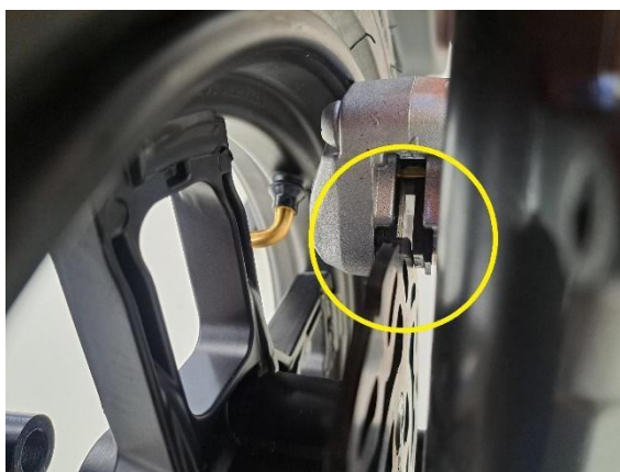
Kontrollera att bromsskivan ligger korrekt mellan bromsbelägen.
