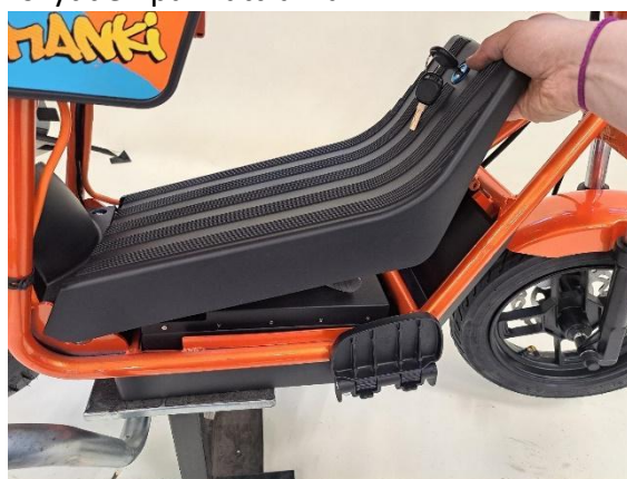
Ta bort batterihöljets lock.
