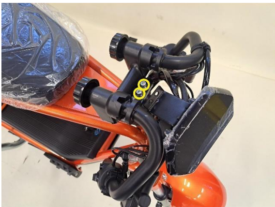
Lossa instrumentpanelens fästbultar (insexnyckel 5 mm).
