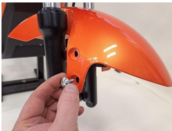
Fäst den främre stänkskärmen med fyra fästbultar (insexnyckel 5 mm).
