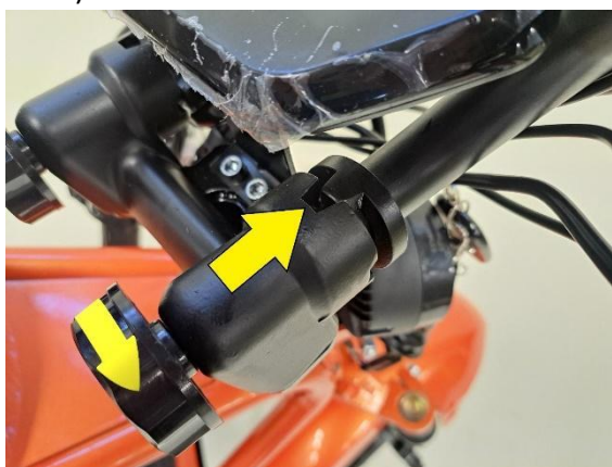
Kontrollera att styrets halvor låses på plats. Dra åt styrhalvornas spännskiva.
