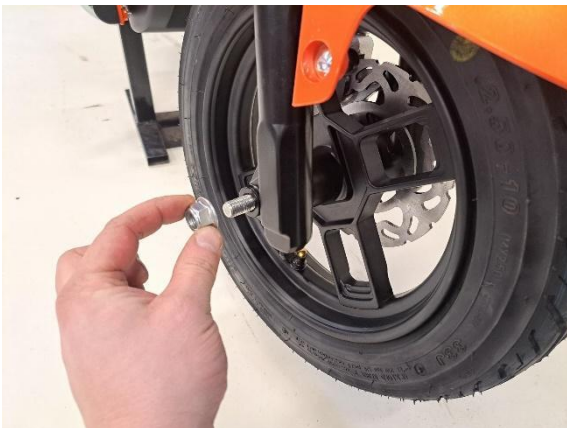
Skjut in framaxeln helt och hållet och sätt fästmuttern på plats (fast nyckel 17 mm).
