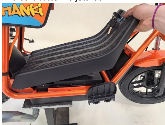
Sätt batterihöljets lock på plats.
