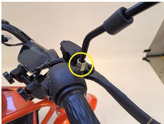
När rätt position har hittats, dra åt muttrarna (fast nyckel 14 mm). Sätt på skydden på muttrarna.
