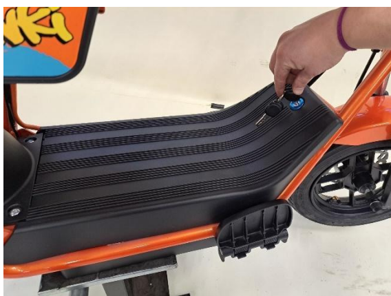
Öppna batterihöljets lock med nyckeln.
