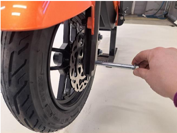
Skjut in framaxeln halvvägs.
