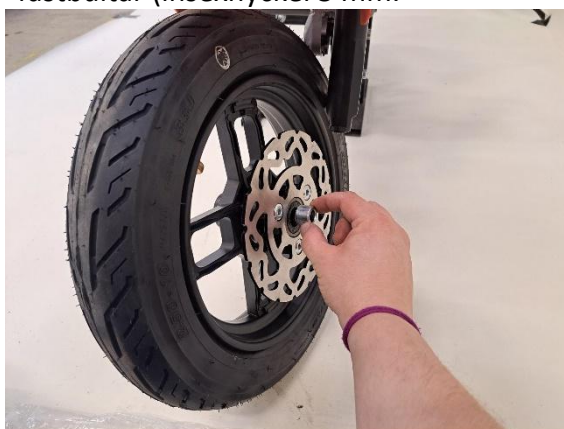
Sätt den kortare bussningen i framhjulet på bromsskivans sida.
