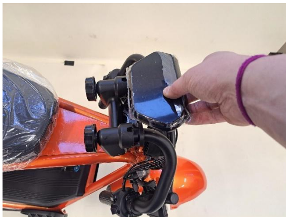
Montera instrumentpanelen på plats med de borttagna fästbultarna (insexnyckel 5 mm).
